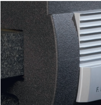
F. I. Technologie : une technique spéciale d'isolation par la mousse sur ZEISS ACCURA réduit au minimum les influences de la température
