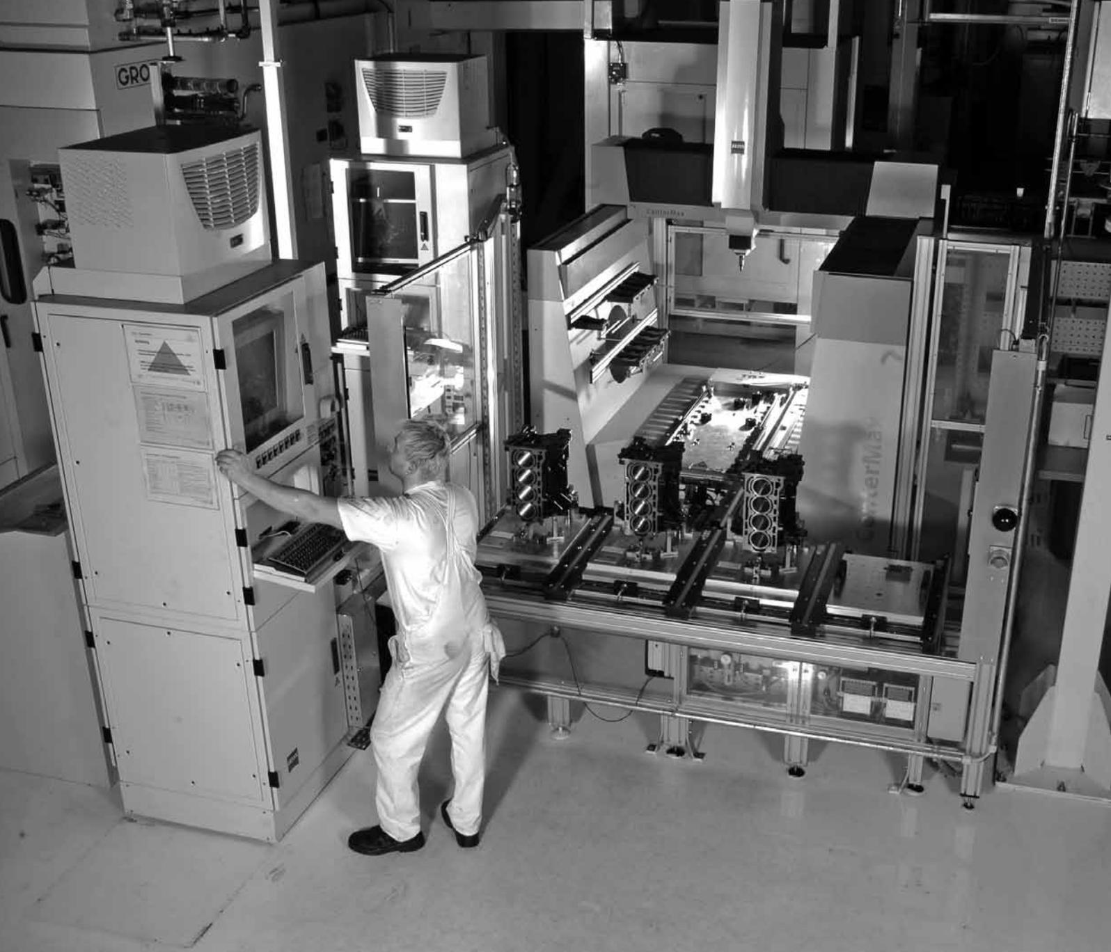
*CenterMax avec système de chargement/déchargement et pupitre de commande*
