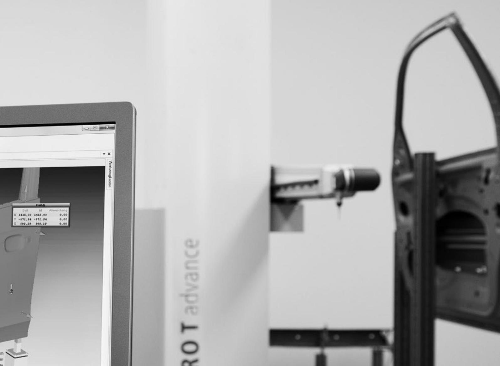
peuvent être importées et mémorisées directement sous la forme de plans de contrôle. La fonction "Synchroniser" compare les listes des éléments de mesure qui ont été modifiés avec le plan de contrôle actuel. Chaque modification est signalée à l'opérateur. Il peut alors accepter la modification en un clic, ou entreprendre des modifications supplémentaires.
