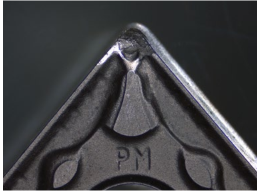
Plaque de coupe; cercle complet éclairage annulaire, zoom 0,8 ×
